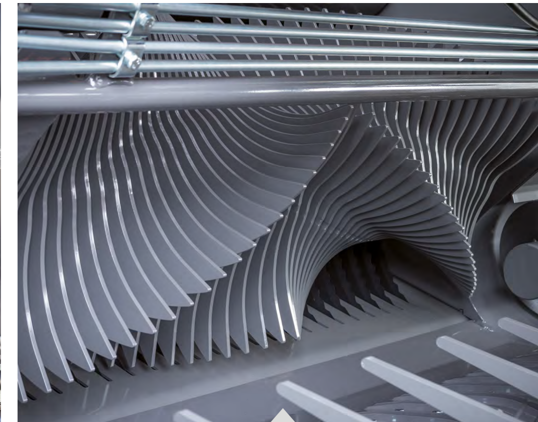
Xtracut o rotor 25 tem design de 4 dentes para maior capacidade de corte
